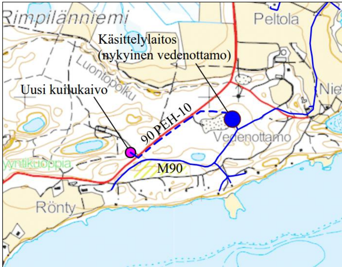
Kuva 8. VE 2: Uusi kuilukaivo ja raudanpoistolaitos.
